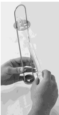
Abb. 5 Einführen bzw. Austauschen eines Viskosimeters mit Lichtschrankenabtastung
