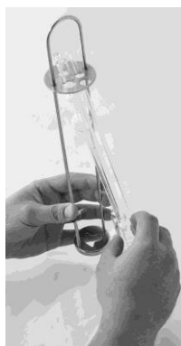
Fig. 5 Inserción o reemplazo de un viscosímetro con detección de barrera de luz
